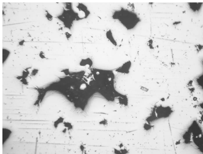
Рис. 3. Фото шлифа с пористостью 11,2%
