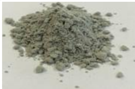
Рис. 1. Вид порошка после химического диспергирования Al-Mo сплава
