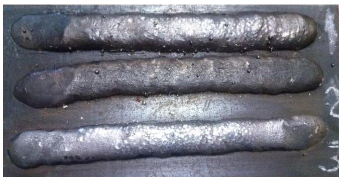
Рис. 3. Валики, наплавленные при увеличенном вылете электрода
