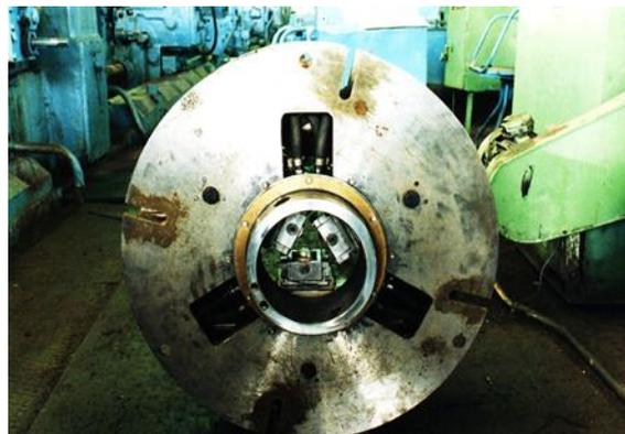
Рис. 1. Роликковая клеть
