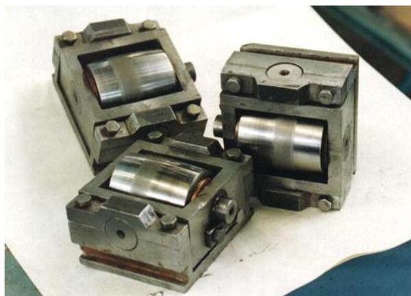
Рис. 3. Быстросъемные кассеты с роликами
