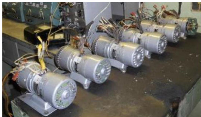
Рис. 8. Общий вид стенда для испытания на преобразователях напряжения ПО-250
