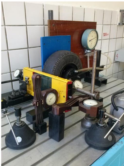
Рис. 3. Фотография экспериментальной установки для измерения боковой деформации шины наклоненного колеса
