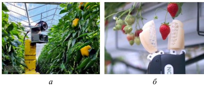
Рис. 2. Примеры существующих МРТК для сбора спелых плодов: а – SWEeper robot (Wageningen UR, Нидерланды); б – Harvesting robot (Octinion, Бельгия)
