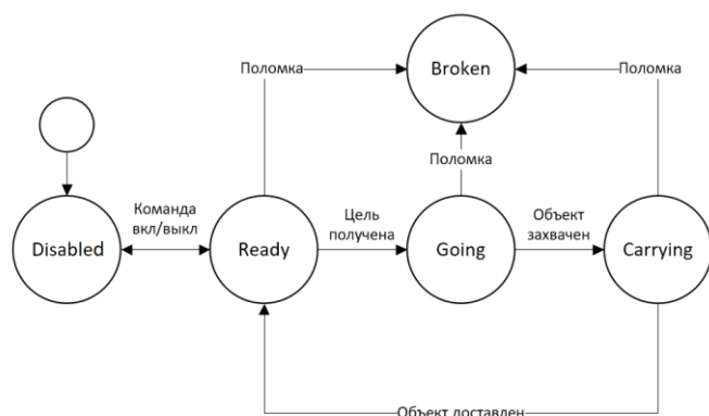
Рис. 5. Диаграмма состояний робота в видеконечного автомата
