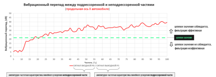
Рис. 5. Иллюстрация примера анализа вибрационного перепада между поддрессоренными и неподдрессоренными частями подвески для направления оси X автомобиля
