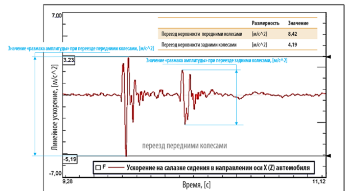
Рис. 6. Пример иллюстрации определения размахов амплитуды для оценки режимов движения автомобиля по единичным неровностям
