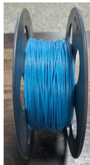
Рис. 1. Внешний вид филамента, изготовленный из материала на основе вторичного ПА6
