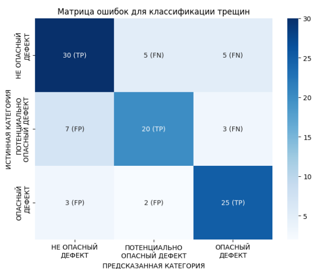
Рис. 1. Матрица ошибок (Confusion Matrix) истинных и ложных классификаций для модели CNN с целью предсказания категории опасности дефекта
