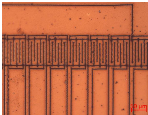
Рис. 3. Фрагмент линейки тензо-резисторов
