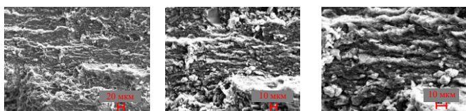
Рис. 1. Структура поверхности природного графита
